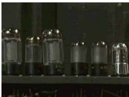
รูป 2.2 หลอดสุญญากาศของ ENIAC
